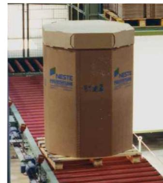
Box-filling (octabin) for PE-granules
