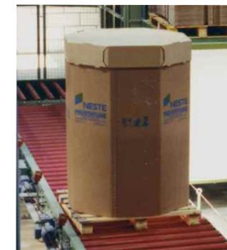
Box-filling (octabin) for PE-granules
