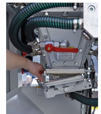
Wartungsklappe am Fülltopf
