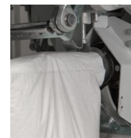
Rückmehlabweisklappe beim Füllvorgang
