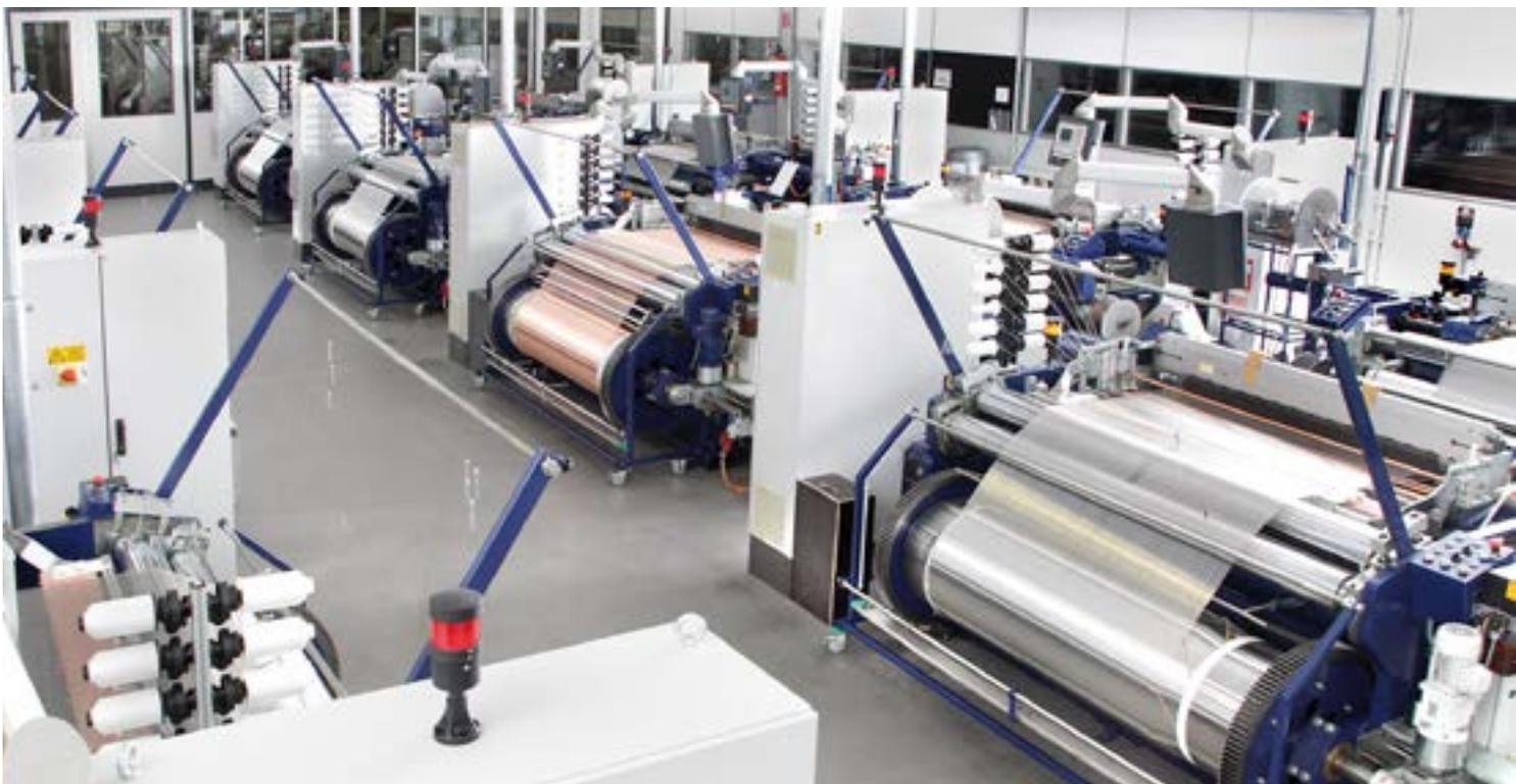
Le cœur de l'usine de tissage métallique est la production de tissu sur des machines à tisser développées par nos soins.
