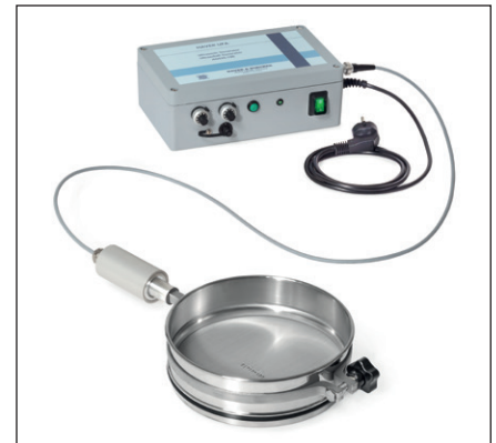
Durch den Einsatz des HAVER UFA wird die Siebung von adhäsiven Schüttgütern ermöglicht
