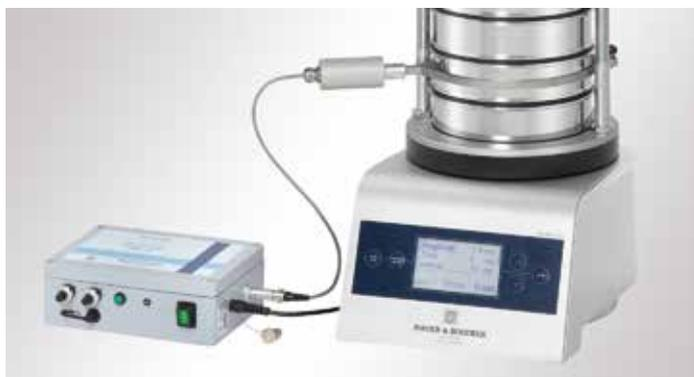
Ultraschall-Frequenzvariation an der Analysensiebmaschine.
