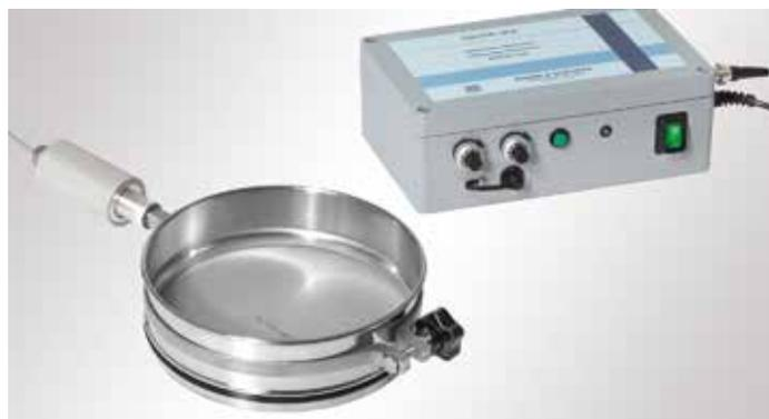
Analysensieb mit Spannring, Konverter und Generator.
