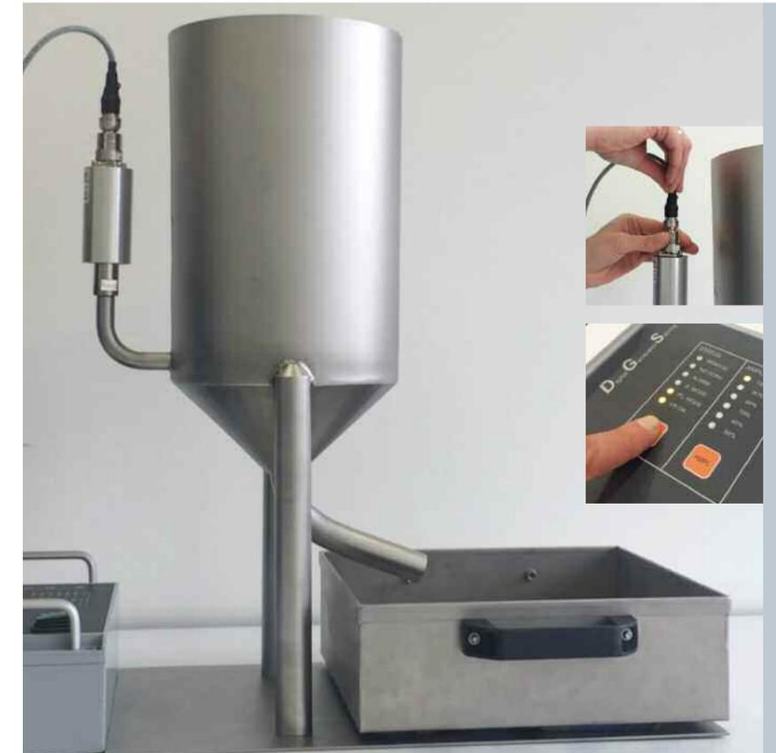
Schüttgut kann an den Innenwänden des Siloausgangs anhaften und durch Brückenbildung ein Abfließen des Materials erschweren.
