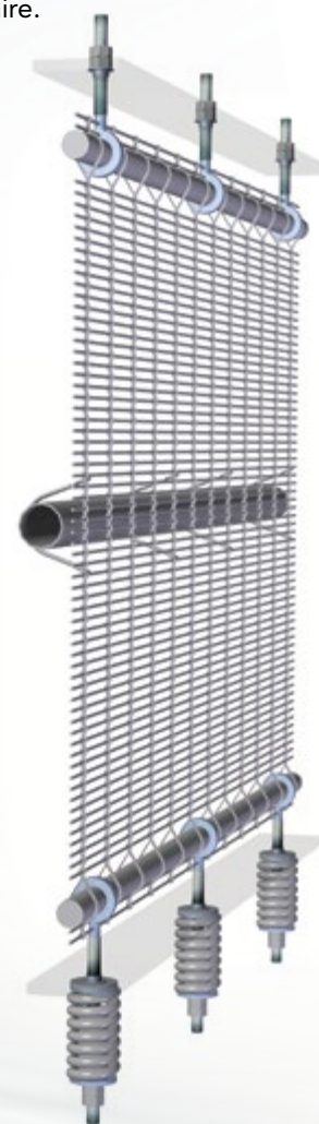
Technique de fixation pour façades en toile à mailles câblées.
