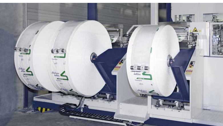
Wägeelektronik MEC® mit Touchpanel / vollautomatischer Rollenwechsler | Vollsacktransport / lange Lagerfähigkeit - auch im Freien
