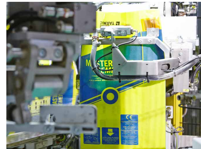
Sackhandling und Aufstecken
