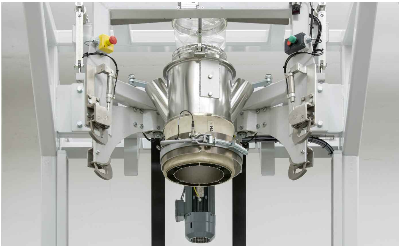
Kompletter Füllkopf mit automatischer Sackabnahme
