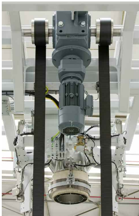
Antriebseinheit für stufenloses Handling
