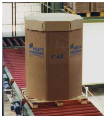
Okabin-Befüllung für PE-Granulate
