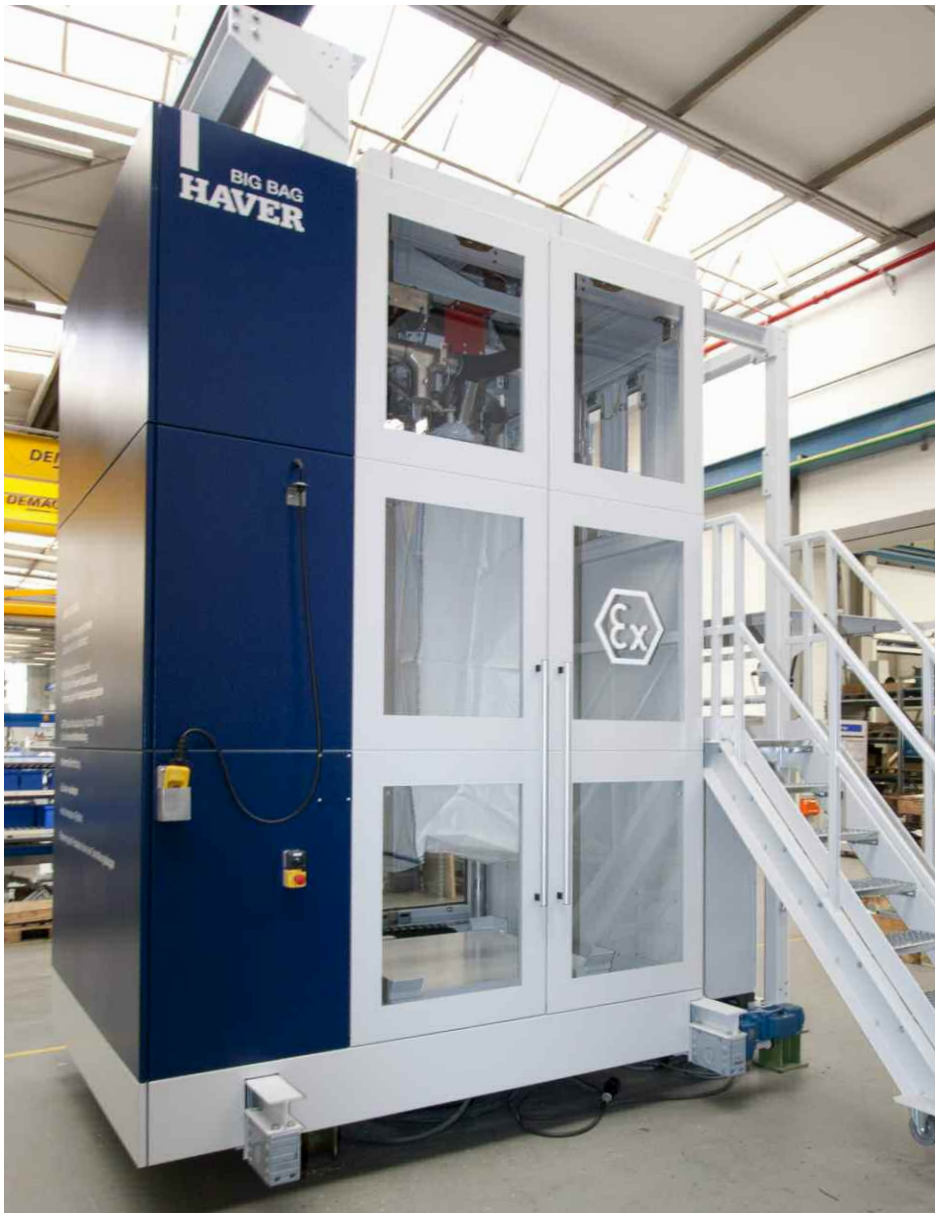
Eingehauste und verfahrbare Big Bag als Reinraum-Anlage (Explosionsschutz)
