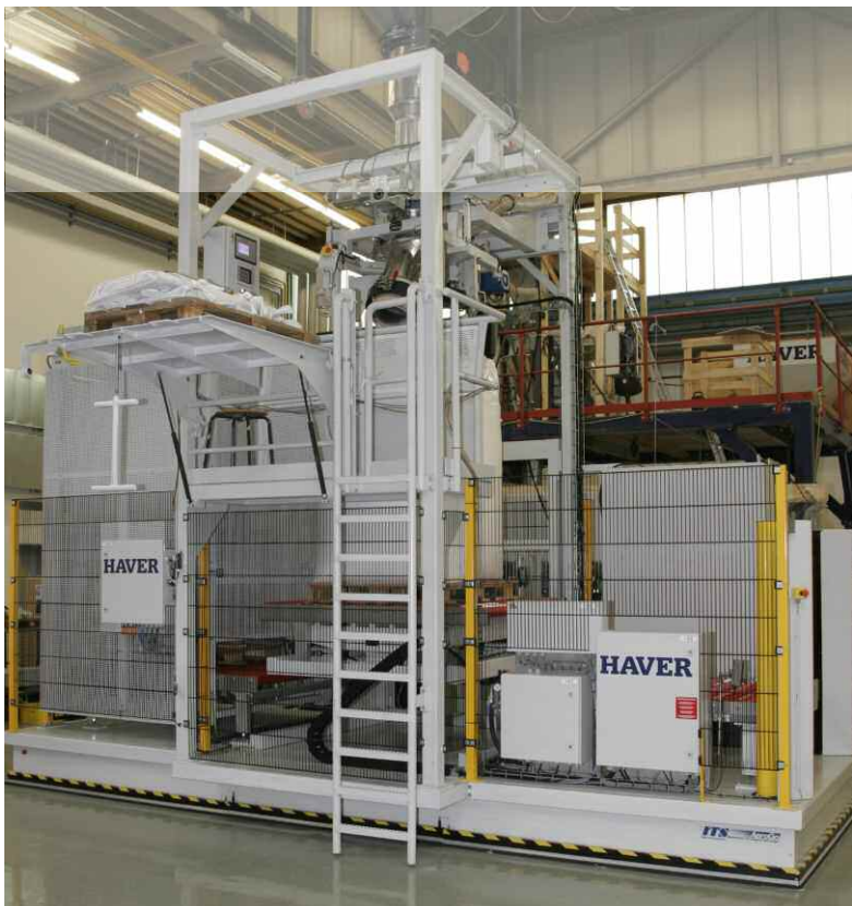
Big Bag-Anlage auf Luftkissen verfahrbar, Sackdoppelung
