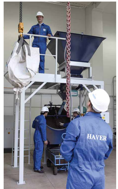
Pelletierversuche mit Eisenerzkonzentrat auf dem HAYER Scarabaeus 1000-Pelletierteller
