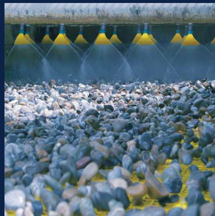
Je nach Baugröße ist die Maschine mit bis zu 38 Düsen ausgestattet.
