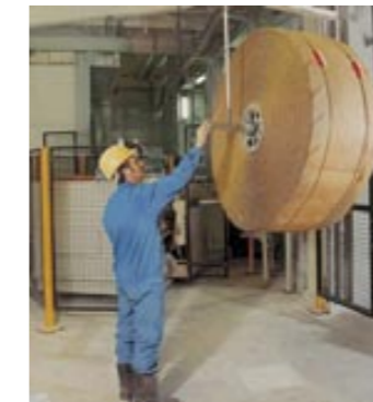
RADIMAT®-Anlagenkonzept mit Rollenmagazin und Leersackhandling bei dem System Rolle
