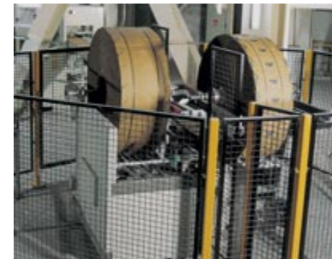
RADIMAT®-Anlagenkonzept mit Rollenmagazin und Leersackhandling bei dem System Rolle
